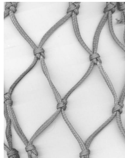
Fig. 4 - Tejido de una red de polietileno
