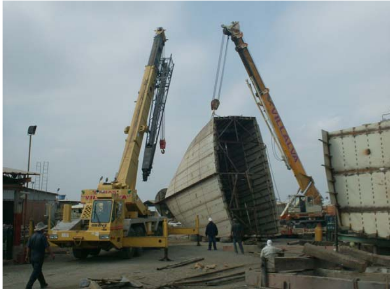
Figura No. 9 Construcción en bloques de barco pesquero sardinero de 55 metros de eslora
