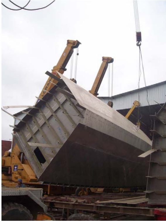
Figura No. 11 Construcción en bloques de aluminio de 2 yates de 45 metros de eslora para las islas Galápagos
