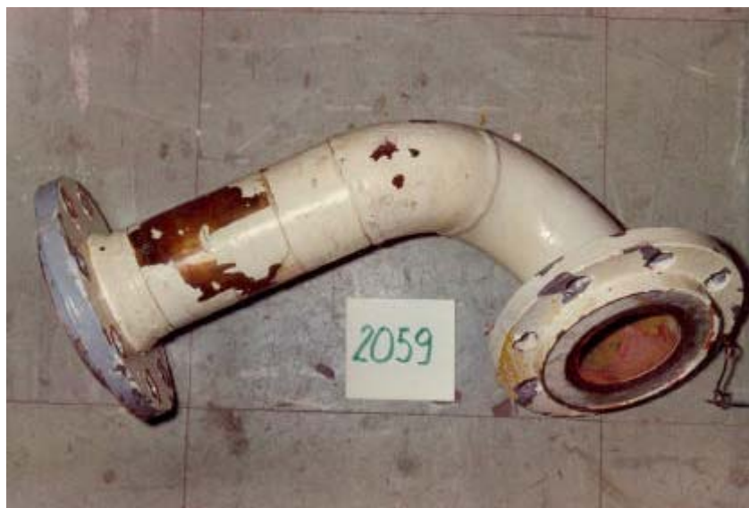
Figura N° 1: Tubería de cuproníquel laminada en caliente
