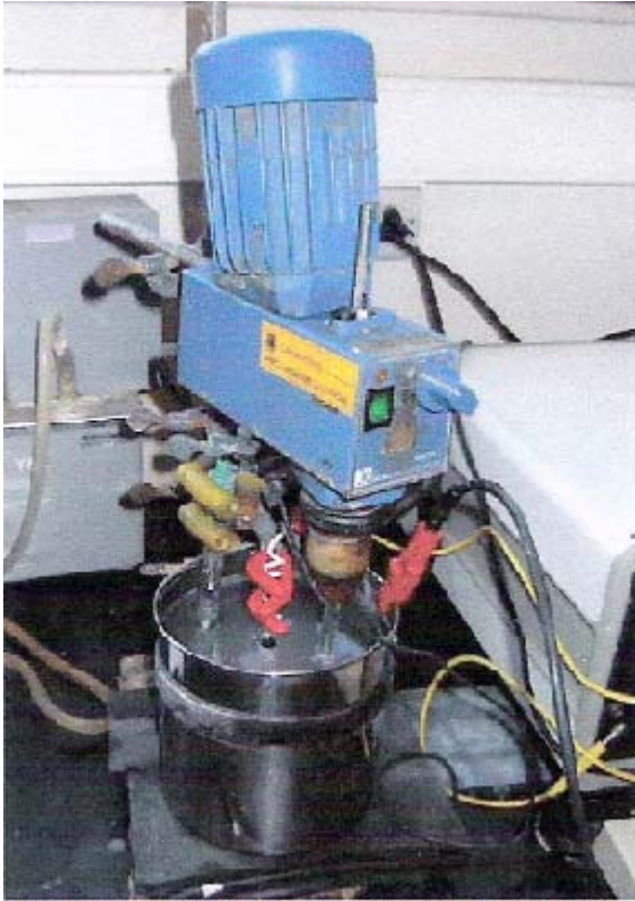
Fig.Nº3,celda experimental y agitador.
