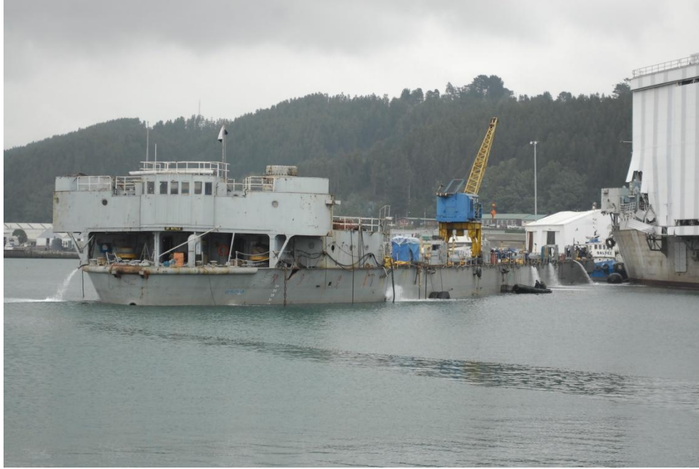
Foto Nº13 Inicio del achique.
