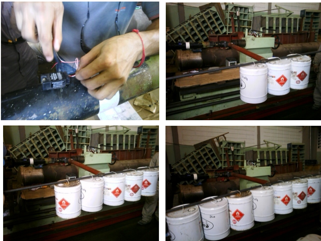
Figura 8. Cargue del eje cardánico con pesos conocidos para producir deformación por torsión.
