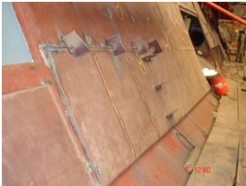
Cambio de chapa envuelta libre circulación
