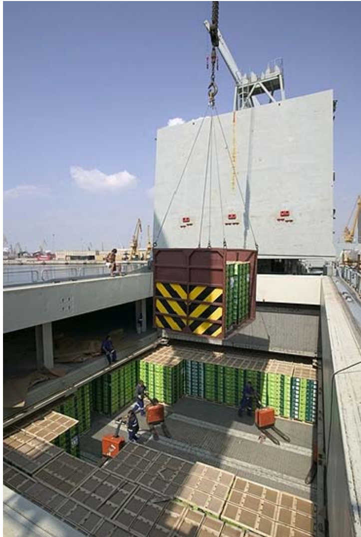
Buque frigorífico descargando con medios propios
