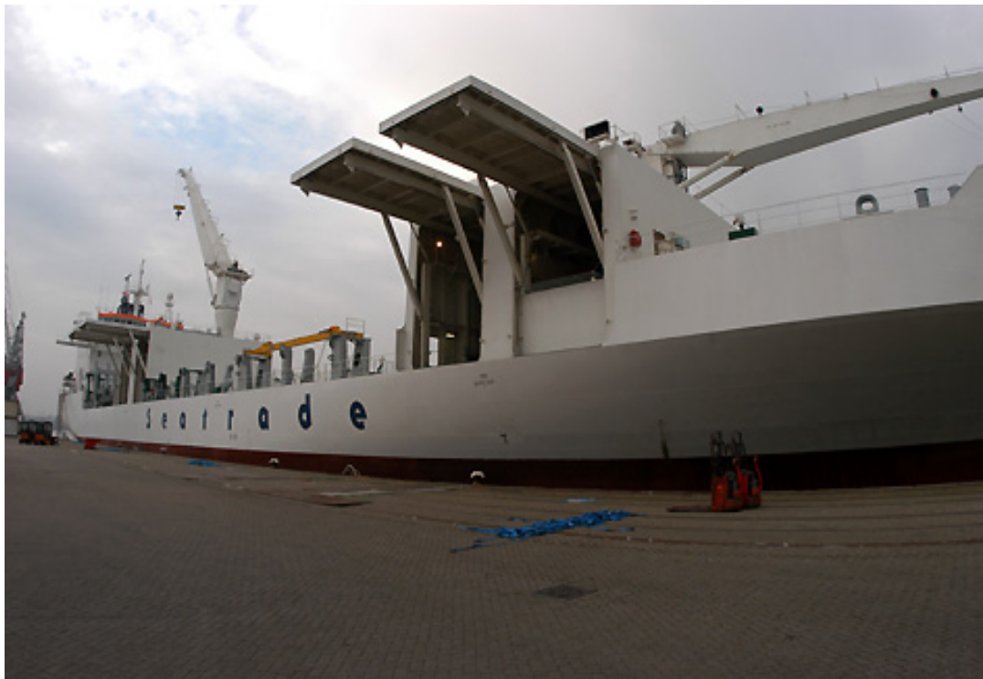
Buque frigorífico dotado de rampas laterales
