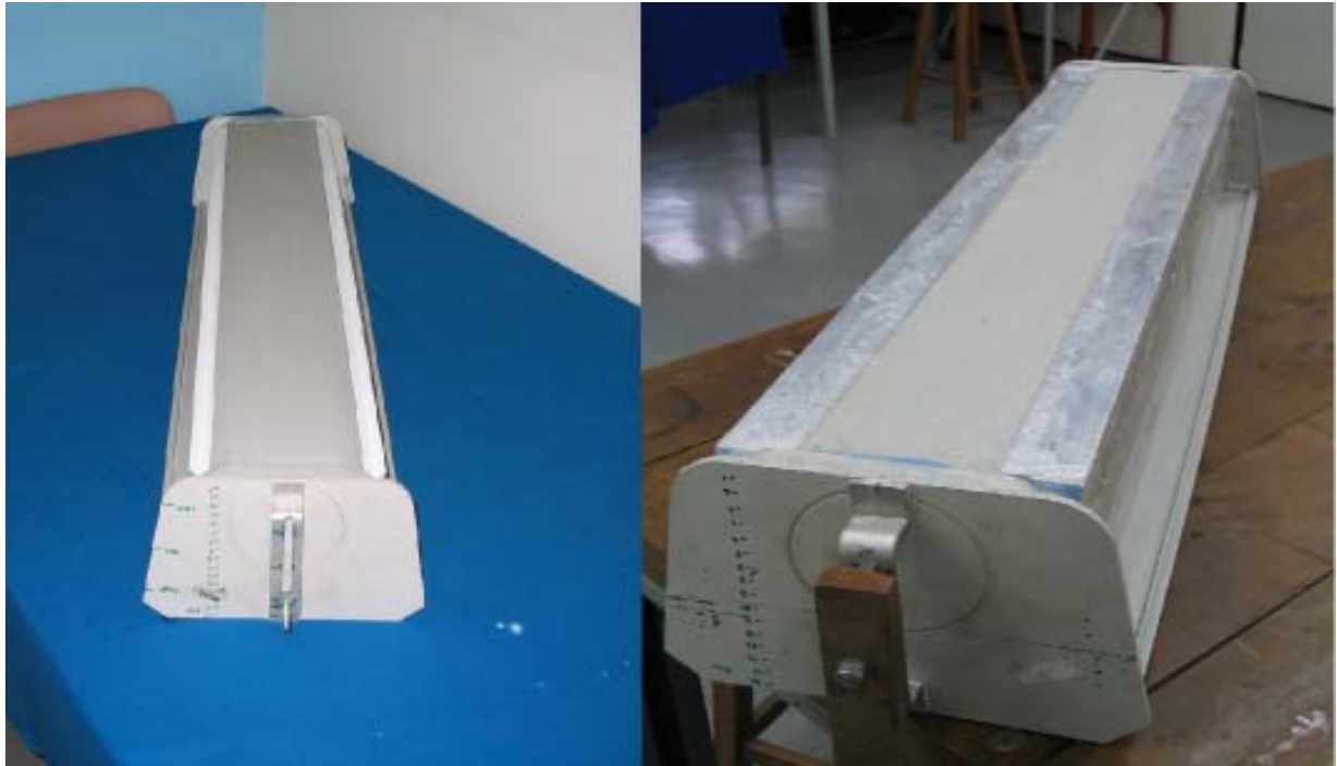
Figura 3 – Duas configurações geométricas ensaiadas: bojo arredondado com bolina (esquerda) e bojo quinado (direita)
