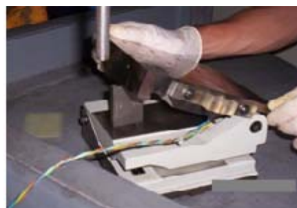
Figura 8.3 – Etapa de calibração do sensor de inclinação
