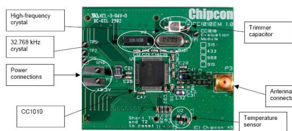
Figure 8.8 – Módulo de Avaliação (Chipcon, 2003).
