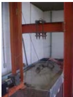
Figura 1.2 – Tanque de ensaios para âncoras.
