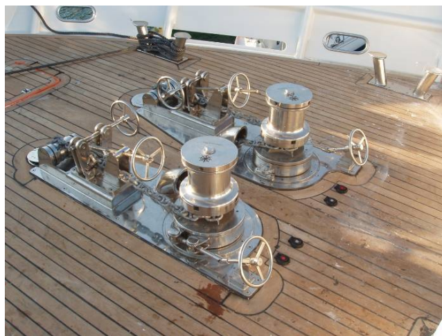
Fig. 3. Pareja de molinetes diseñados y fabricados por Carral Marine Technology, instalados en un megayate.
