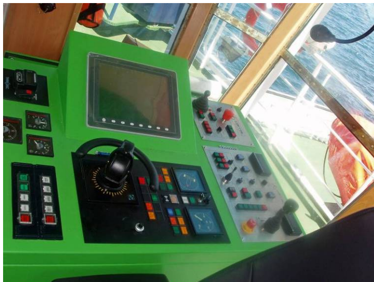
Fig. 5. Pantalla y Consola de Mando en Puente en un buque remolcador.
