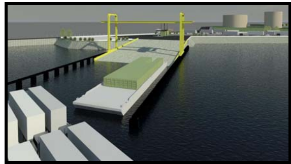
Figura 12 - Rampa roll-on/roll-off com pódio para contêineres
