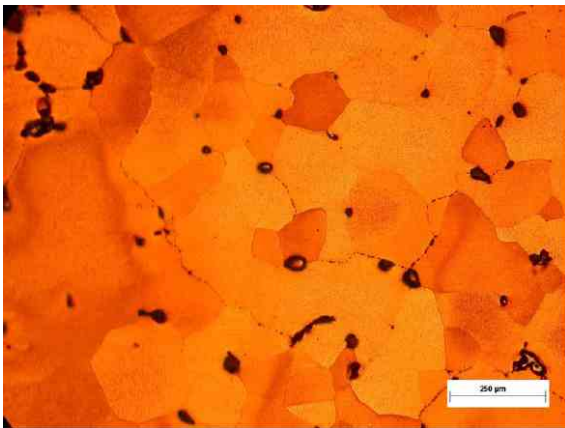
Figura 6: Aspecto geral da microestrutura da seção radial mostrando grãos da liga monofásica \alpha de CuSn, vazios e partículas grosseiras de Pb onde podem ser observados também finos precipitados decorando os contornos. Detalhe 1 da figura 5.
