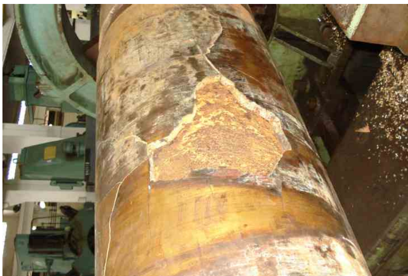
Figura 2: Detalhe da camisa do eixo trincada mostrando uma região em que houve destacamento de parte da camisa e numerosas trincas secundárias e produtos de corrosão na parede do eixo de aço.
