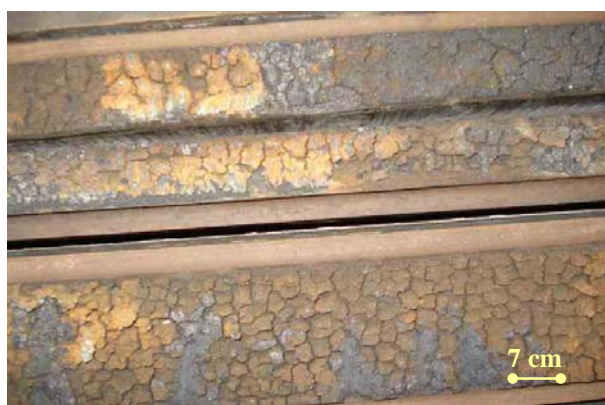
Figura 21: Fotografia da superfície das “taliscas” da região da camisa danificada e a nova pronta para ser instalada
