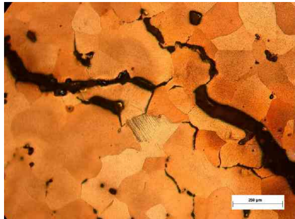
Figura 11: Detalhe da região da figura 10 mostrando com maior aumento a presença de trincas secundárias intergranulares.
