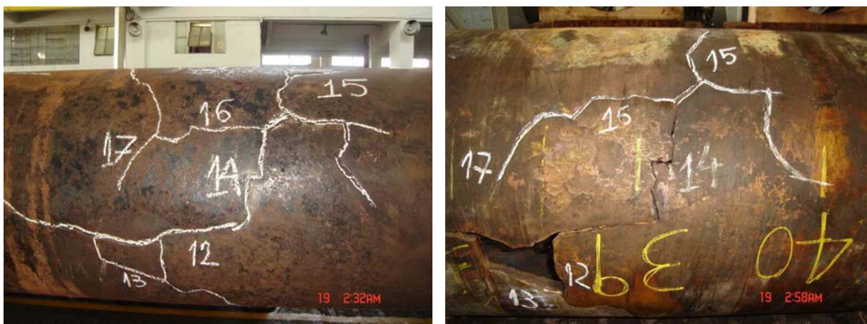
Figura 22. Vista do eixo com realce das linhas de corrosão e vista da camisa com realce das trincas coincidentes com a corrosão do eixo.
