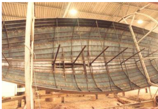
Figura 11 - Dispositivo de fabricação que permite rotacionar a embarcação em 360 graus
