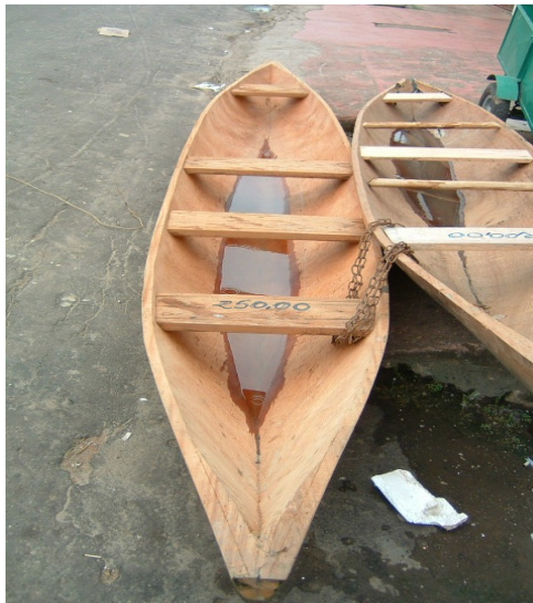
Figura 2 - Casco produzido de apenas um tronco de árvore.
