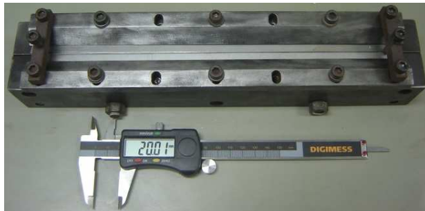
Gabarito utilizado na fabricação dos reforçadores
