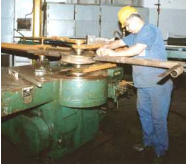
DOBRAMENTO A FRIO DE TUBOS
