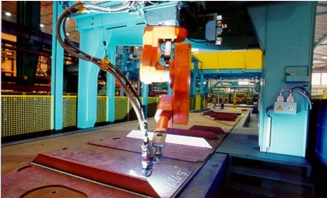
Fig. 38: Welding Robot in operation on sub assembly line at Howaldtswerke-Deutsche Werft AG. Courtesy of Howaldtswerke-Deutsche Werft AG
