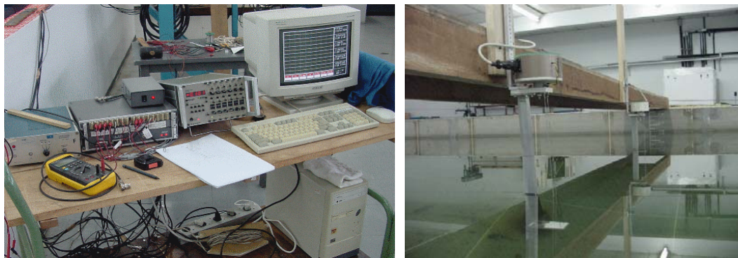
Figura 4 - Vista da bancada de instrumentação e dos medidores de ondas
